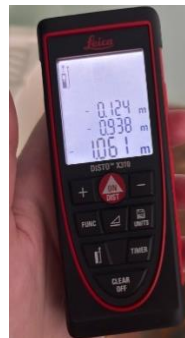
Рисунок 4 – Непрерывные измерения лазерным дальномером Leica DISTOTM X310
