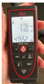
Рисунок 7 – Определение площадей лазерным дальномером Leica DISTOTM X310
