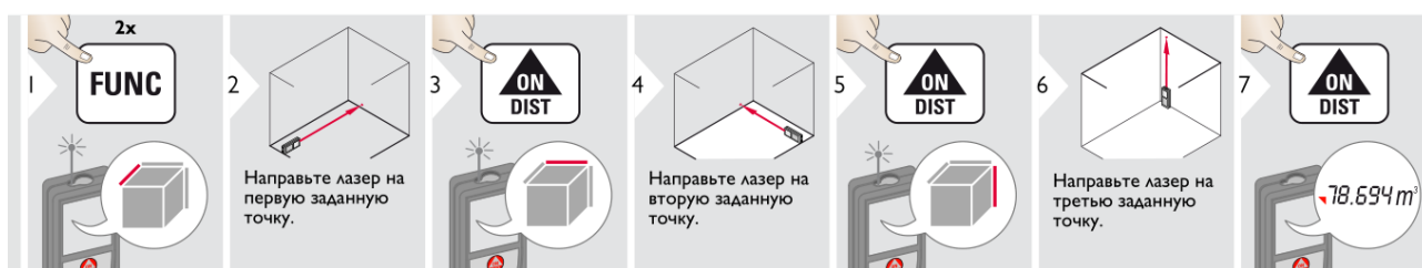
Рисунок 8 – Определение объемов лазерным дальномером Leica DISTOTM X310
