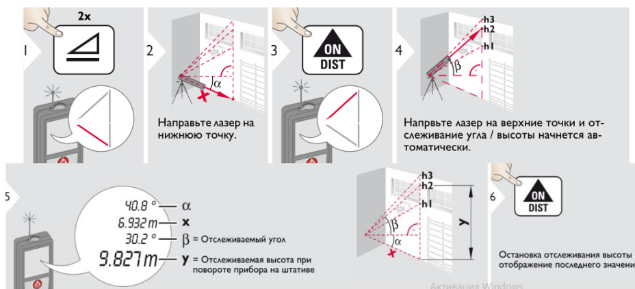
Рисунок 14 – Определение недоступных расстояний через угол наклона лазерным дальномером Leica DISTOTM X310
