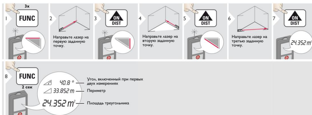
Рисунок 10 – Определение площадей треугольника лазерным дальномером Leica DISTOTM X310
