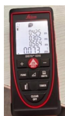
Рисунок 9 – Определение объемов лазерным дальномером Leica DISTOTM X310
