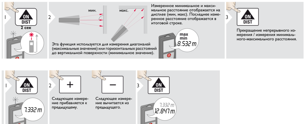
Рисунок 4 – Непрерывные измерения лазерным дальномером Leica DISTOTM X310
