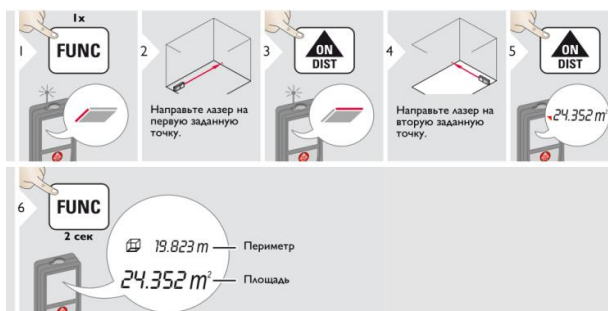
Рисунок 6 – Определение площадей лазерным дальномером Leica DISTOTM X310
