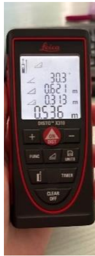
Рисунок 15 – Определение недоступных расстояний через угол наклона лазерным дальномером Leica DISTOTM X310
