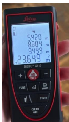
Рисунок 11 – Определение площадей треугольника лазерным дальномером Leica DISTOTM X310
